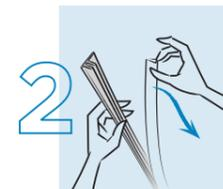
Séparez les faces avant et arrière du profil de finition. Installez la face arrière sur le mur.
